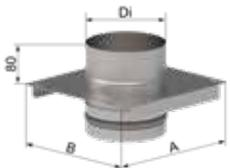
**20057ZC## - Zwischenstütze für Profil-Konsole** **RG: 3U**
