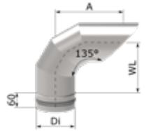
nicht drehbar | Gitter zum Schutz vor Fremdkörpern enthalten
